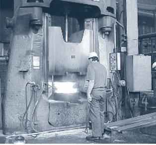
Mit dem Zug reisten wir am 16. Januar nach Oberburg. Bei Flükiger & Co. AG erhielten wir einen Einblick in die Warmumformung. Besonders imposant war die Zusammenarbeit dreier Schmiede-Facharbeiter, die durch geschicktes Hantieren und Teamarbeit aus einem quaderförmigen, glühenden ca. 100 kg schweren Stahlklotz ein kreuzförmiges Schmiedeteil für den Maschinenbau herstellten.
